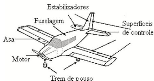
Figura 1. Principais componentes do avião
