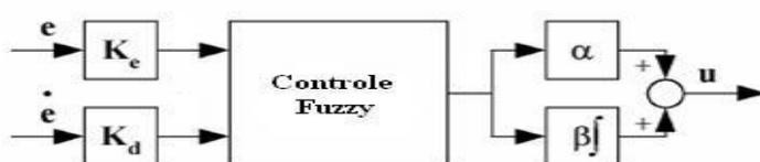
Figura 4. Estrutura do controlador Fuzzy-PID
