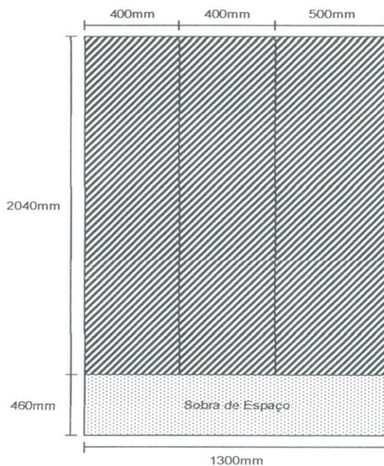
Figura 8: **Padrão 8** .Produção de 2 painéis de 400mm e 1 painel de 500mm sem sobra de espaço.
